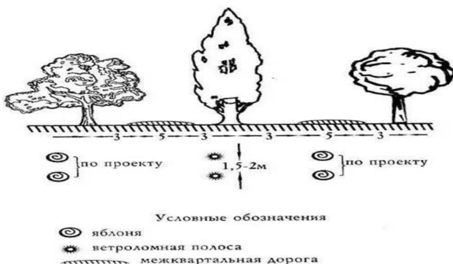
Схема 2. Конструкция ветроломных сазозащитных полос в питомнике
