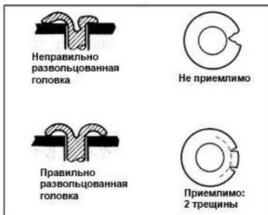
Рисунок 3.4 – Определение правильности выполнения расклепывания тормозных накладок
