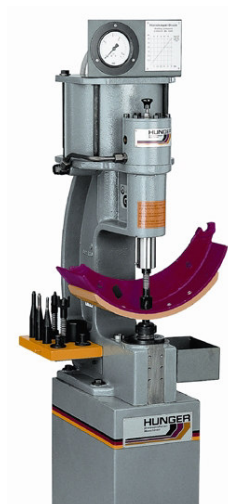
Рисунок 1.11 - Гидропневматический стенд для клепки и расклейки накладок тормозных колодок HUNGER N322 (Германия)
