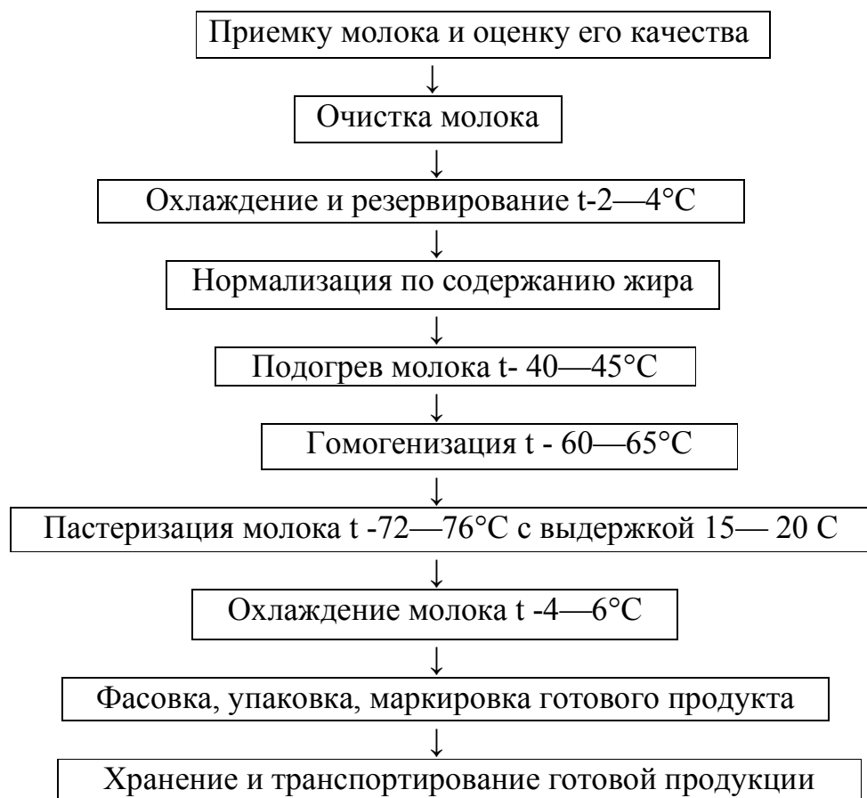
Рисунок 2 - Технологическая схема производства пастеризованного молока
