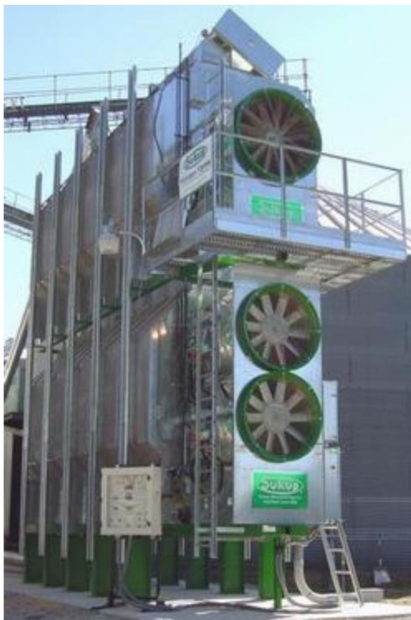
Рисунок 4 - Зерносушилка "Sukup" двухмодульная TE 1652E
