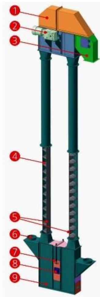
1 – головка, 2 – мотор редуктор, 3 – выгрузка, 4 - ковши, 5- датчики сбега ленты и подпора, 6 – выгрузка, 7 – винтовое натяжное устройство, 8 – датчик контроля скорости ленты, 9 – башмак.
