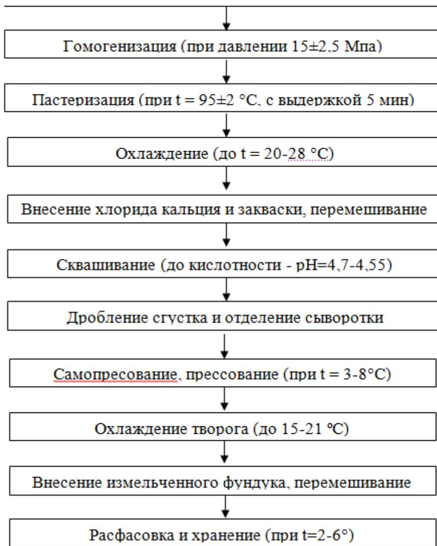
Рисунок 2 – Схема технологии производства творога с фундуком
