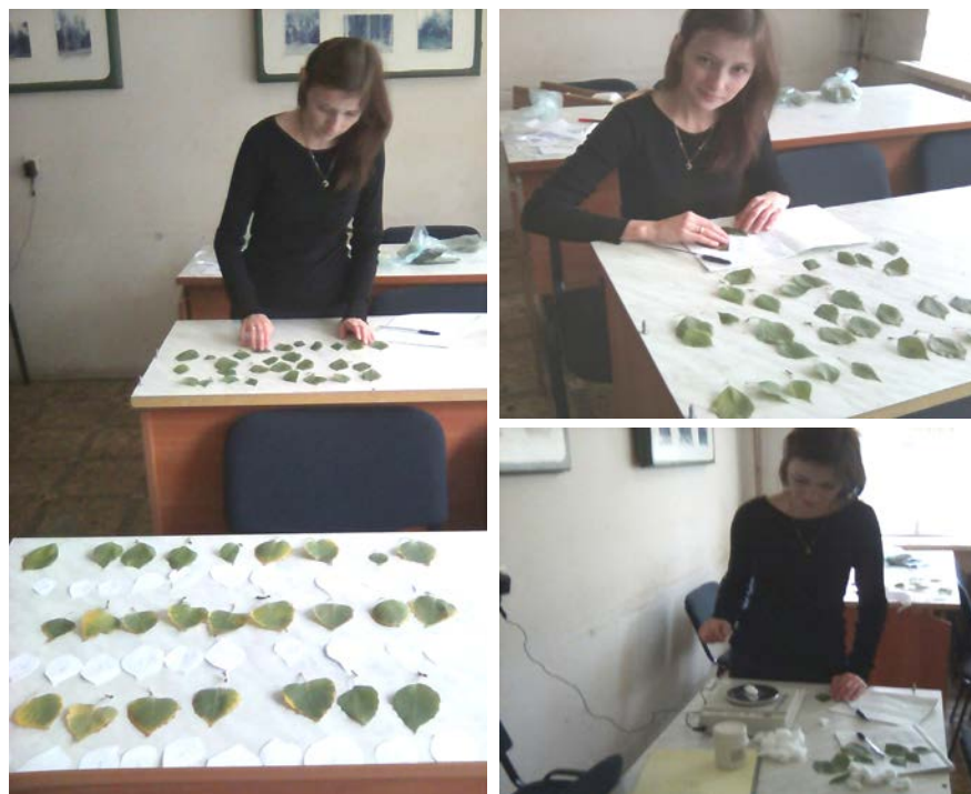
Рис.9. Процесс определения пылезадерживающей способности листьев березы
