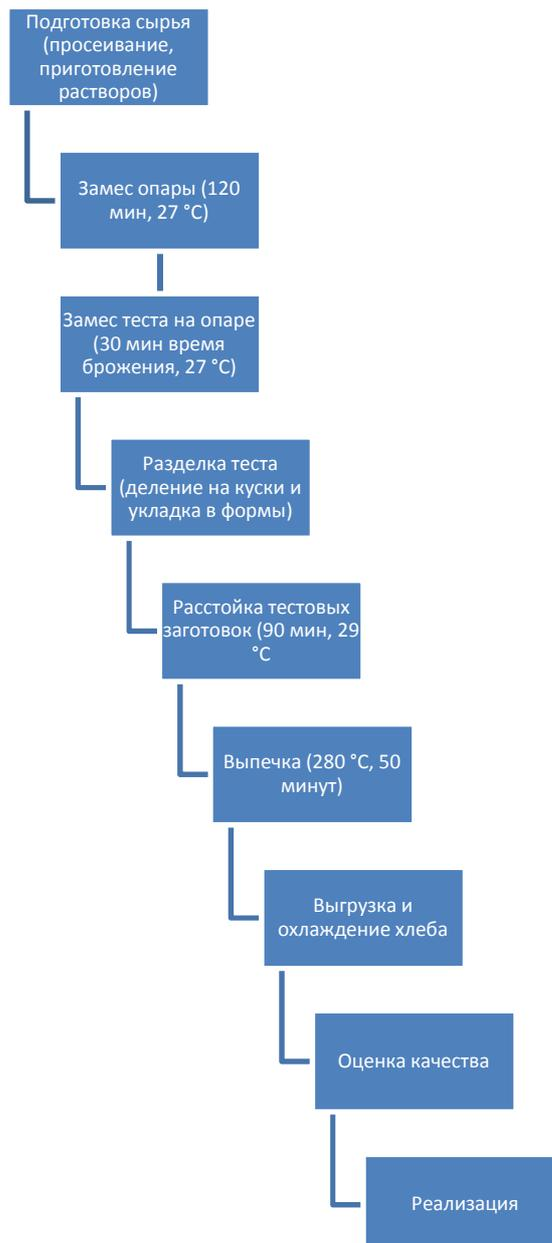
Рисунок 1 - Блок-схема производства хлеба из муки в/с
