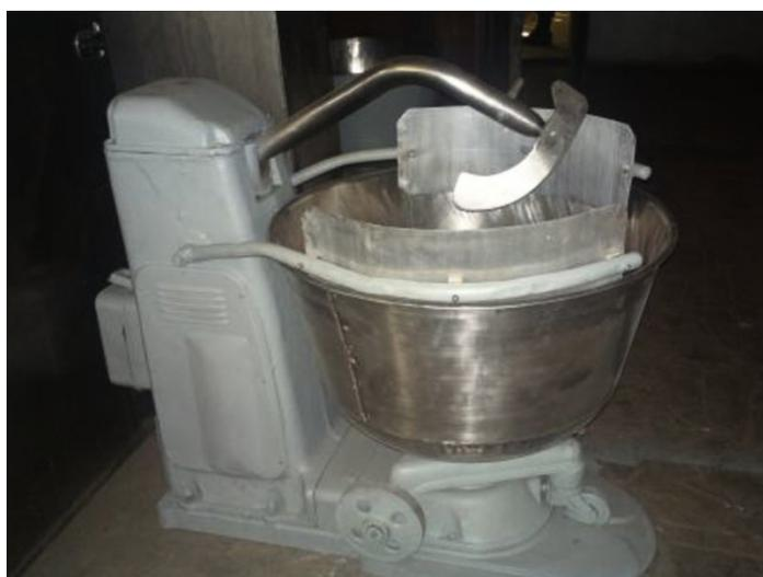
Рисунок 3-Тестомесительная машина ТММ-1М
