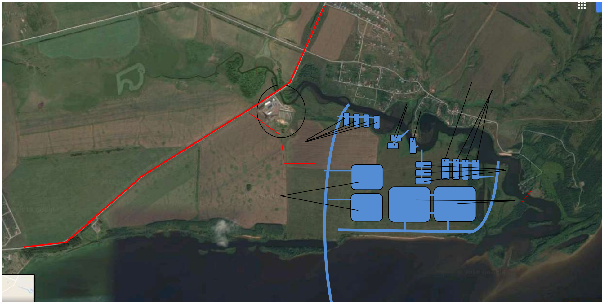
Рис. 3 Блок-схема предполагаемого рыбоводного хозяйства с использованием карт «Гугл Земля». 1 - Зимовальные; 2 - нерестовые; 3 - воростные; 4 - нагульные; 5-маточные; 6 - ремонтные; 7-садки; 8- карантинные пруды —обозначение дорожного маршрута
