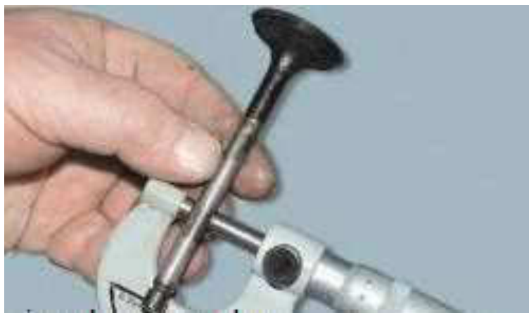
Рисунок 2.2 - Измерение диаметра стержней клапанов двигателя Д - 260.
