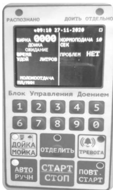
Рисунок 1 – Блок управления доением НПП «Агромакс»
