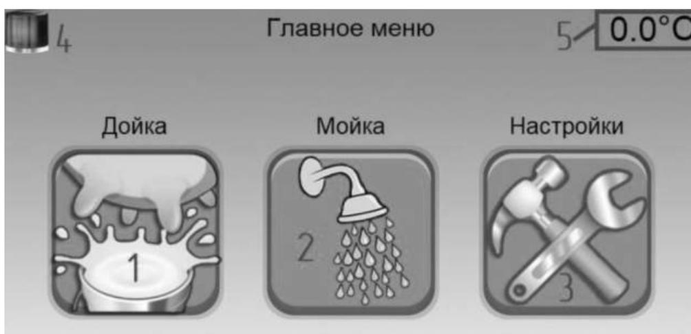
1 – кнопка перехода в режим «Дойка»; 2 – кнопка перехода в режим «Мойка»; 3 – кнопка перехода в меню настройки; 4 – индикация аварии; 5 – индикация текущей температуры моющего раствора
