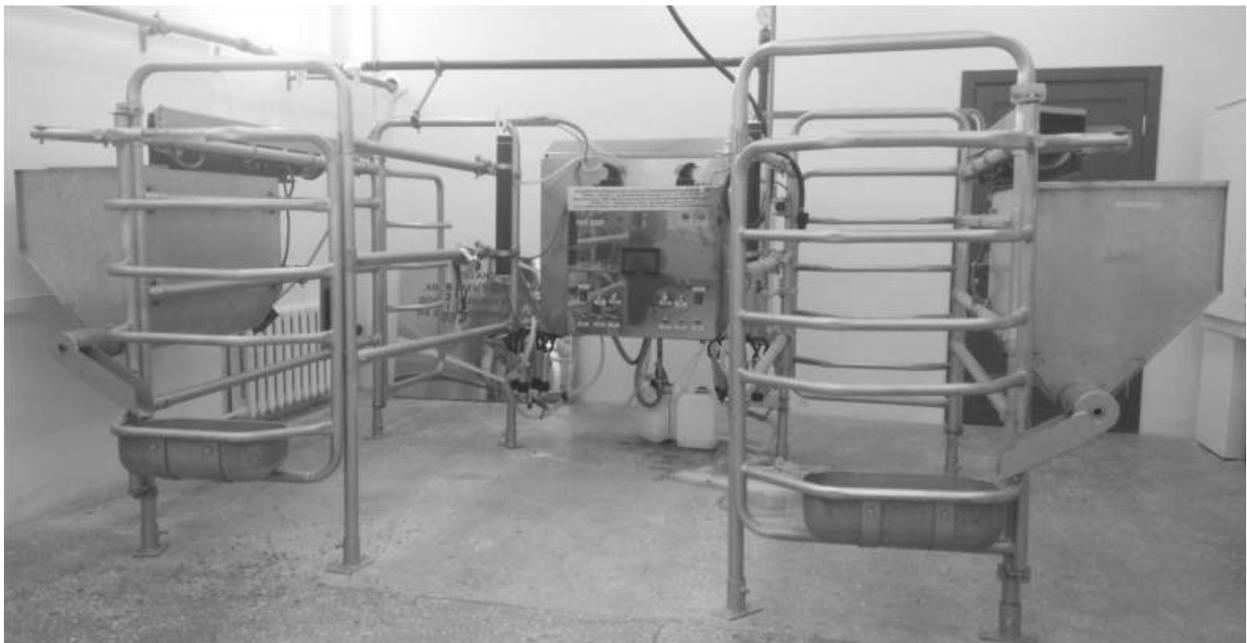
Рисунок 3 – Общий вид автоматизированной доильной установки добровольного доения
