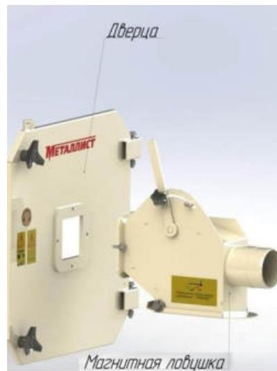
Рисунок 2 – Устройство пневматического сепаратора дробилки ДКМП
