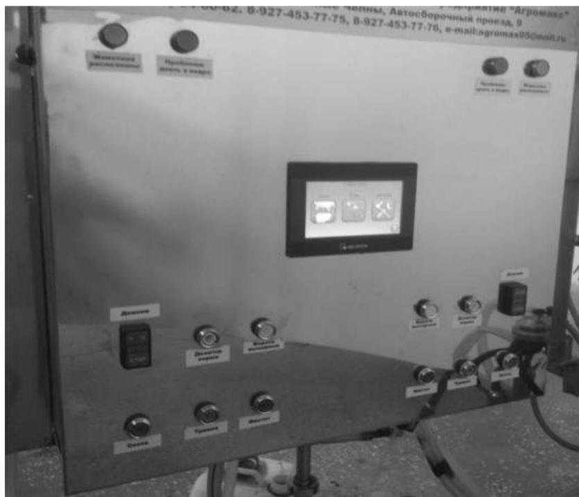
Рисунок 4 – Шкаф управления вид сзади
