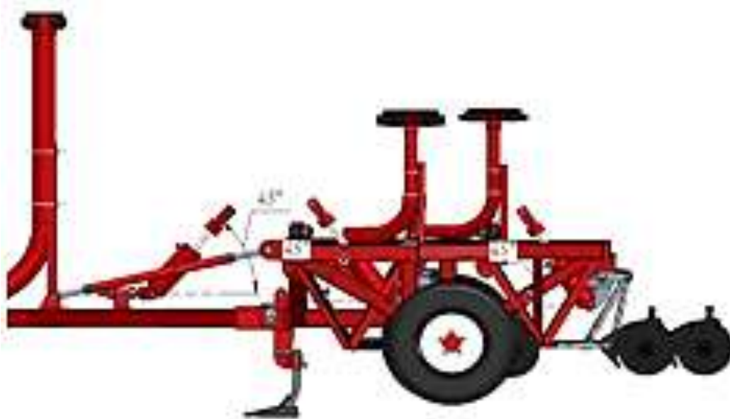
Рисунок 18 – Положение гидроцилиндров при стравливании воздуха
