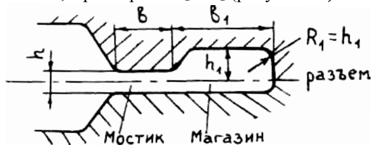
Рисунок 24 Форма облойной канавки для молотовых штампов
