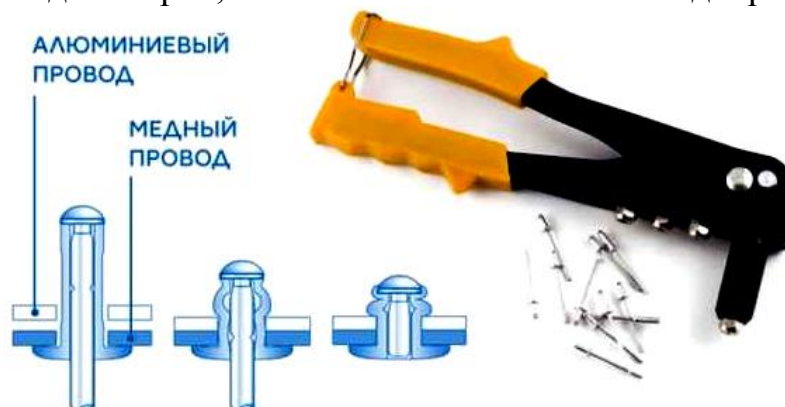
Рисунок 13 – Неразъемное соединение проводников заклепкой
