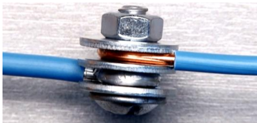
Рисунок 9 – Соединение проводов с помощью винтов и гаек.
