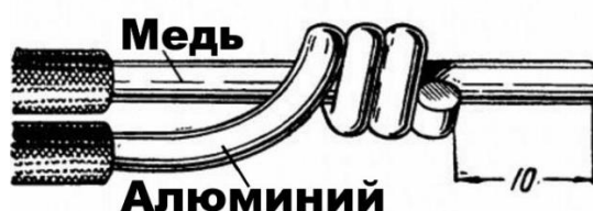
Рисунок 6 – Сварка медного и алюминиевого проводов.
