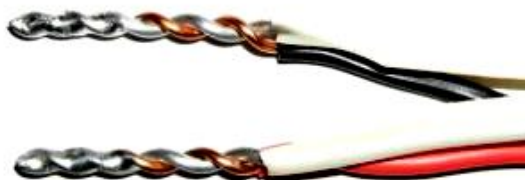
Рисунок 8 – соединение проводов скруткой
