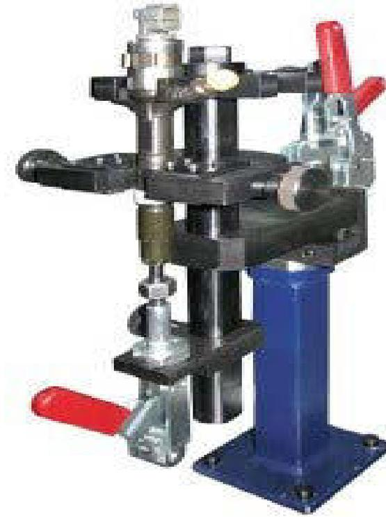
Рисунок 3.1 Устройство для разборки-сборки форсунок фирмы Bosch
