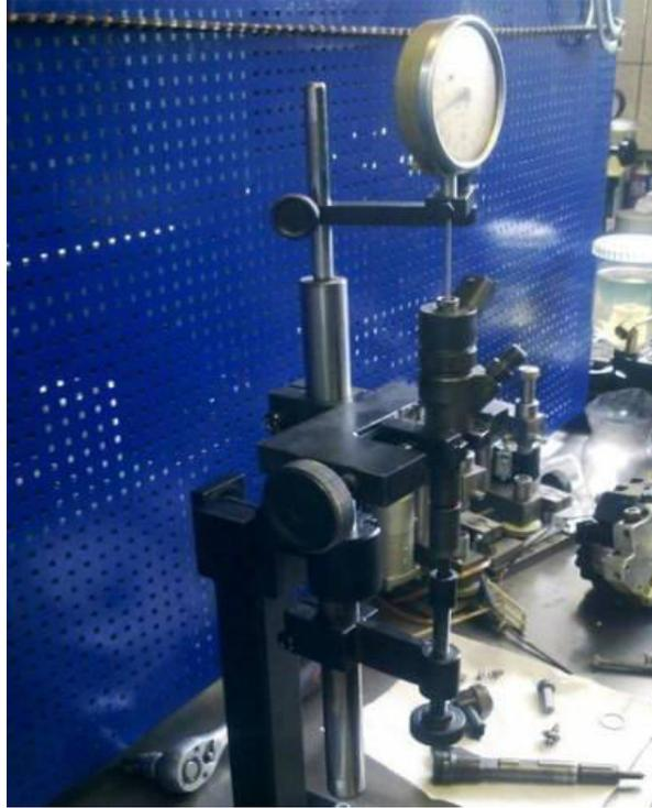
Рисунок 3.3 Стапель для разборки-сборки Step3 форсунок
