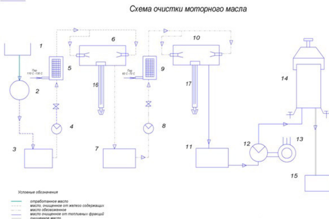
Рисунок 3.1 Принципиальная гидравлическая схема очистки загрязненного масла на стационарной установке
