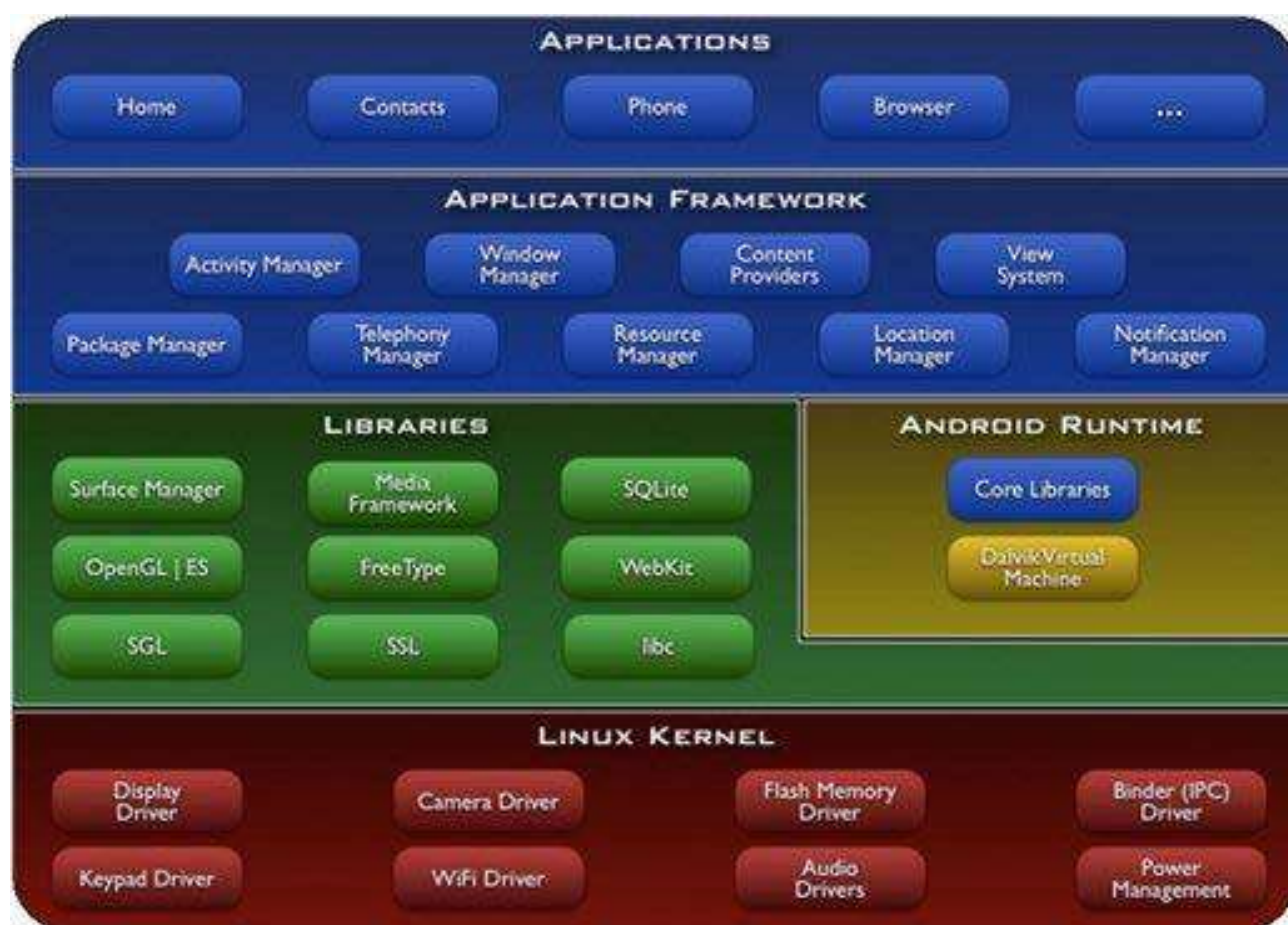
Рис. 12 – Архитектура операционной системы Android
