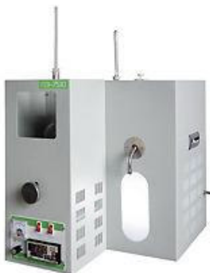
Рисунок 2.3 – Установка для дистилляции нефти при атмосферном давлении со встроенным нагревателем бани
