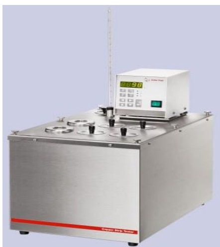
Рисунок 2.7 Аппарат СС-ФА6 для определения коррозионного воздействия нефтепродуктов на медную пластинку.
