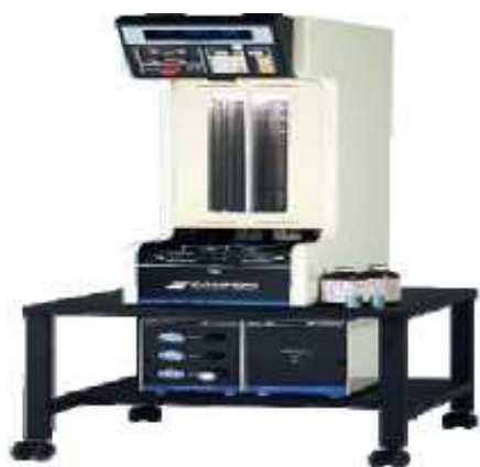
Рисунок 2.2 – Приборы для определения вязкости: CAV 2100 - одна баня, 2 вискозиметра; CAV 2200 - две бани, 1 вискозиметр в каждой.
