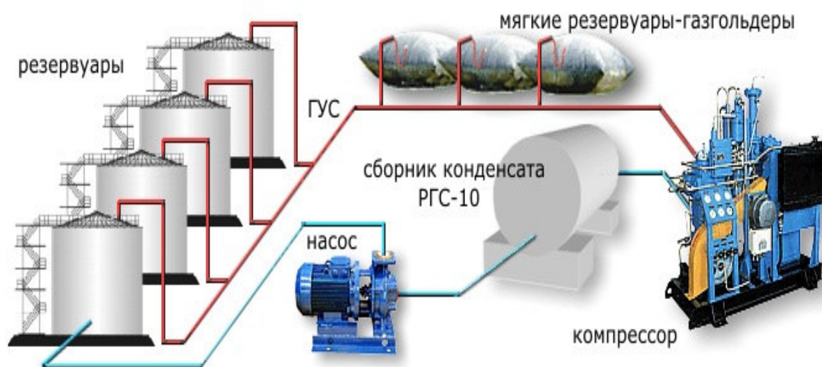
Рисунок 2.15 – Схема преобразования паровоздушной смеси в жидкость и её возврат в резервуар
