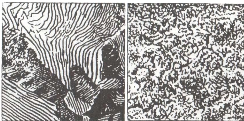
Рисунок 3.3 Микроструктура эвтектоидных сталей:
