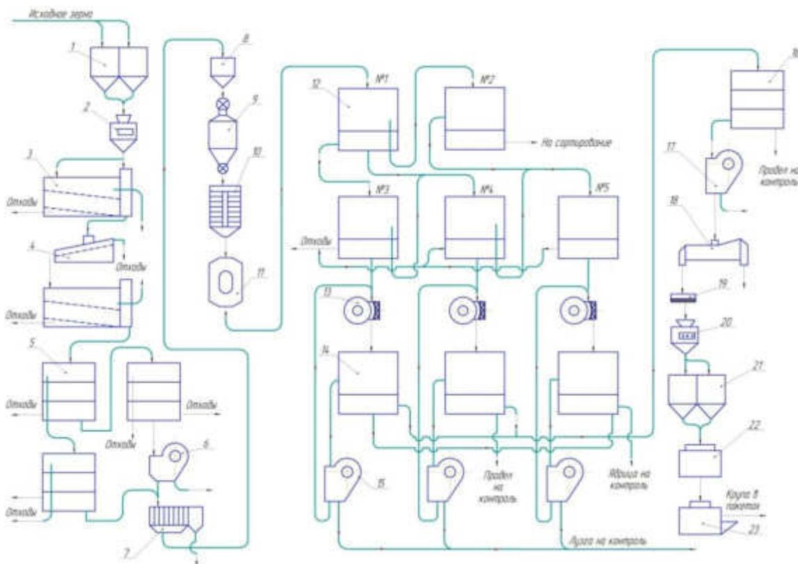
1-бункер; 2-автоматические весы; 3-воздушно-ситовый сепаратор; 4-камнеотделитель; 5-рассев; 6-аспиратор; 7-овсюгоотборник; 8-бункер; 9-установка для ГТО; 10-паровая сушилка; 11-охладительная колонка; 12-рассев; 13-валцедоковый станок; 14-бункер; 15-аспиратор; 16-рассев; 17-аспиратор; 18-падди-машина; 19-магнитный сепаратор; 20-весы; 21-силос; 22-фасовочная машина; 23-упаковочная машина.
