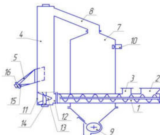
1 – питающий конвейер; 2 – загрузочный бункер; 3 – аспирационный патрубок; 4 – вертикальное транспортирующее устройство; 5 – сопло; 6 – патрубок подвода пара; 7 – пропарочная камера; 8 – загрузочный патрубок; 9 – дозатор; 10 – датчик уровня зерна; 11 – корпус; 12 – загрузочное окно; 13 – витки; 14 – шнек; 15 – щель; 16 – нижняя кромка.
