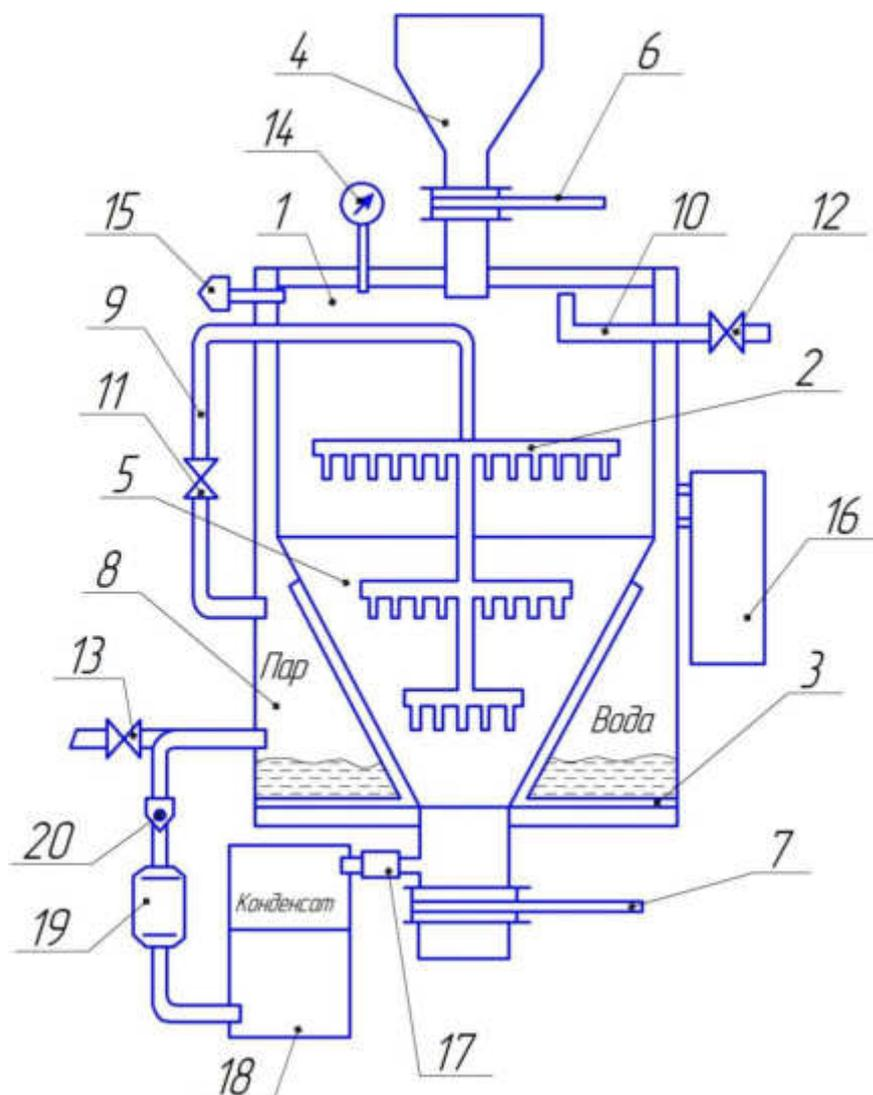
1 – рабочая камера; 2 – змеевик; 3 – нагревательный блок, 4 – приемный патрубок; 5 – выгрузной патрубок; 6,7 – затворы; 8 – парообразователь; 9,10 – трубопровод;
