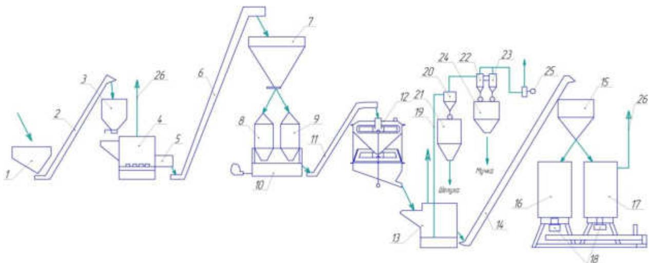
1-приёмный бункер; 2-нория; 3-бункер; 4-семяочистительная машина; 5-триер; 6-нория; 7-бункер; 8-пропариватель; 9-пропариватель; 10-отволаживатель; 11-нория; 12-пневмомеханический шелушитель; 13-семяочистительная машина; 14-нория; 15-бункер крупы; 16,17-вертикальный сушильный аппарат; 18-фасовочная машина; 19-трубопровод; 20-циклон; 21-бункер; 22,23-батареяный циклон; 24-бункер; 25-вентилятор; 26-трубопровод.
