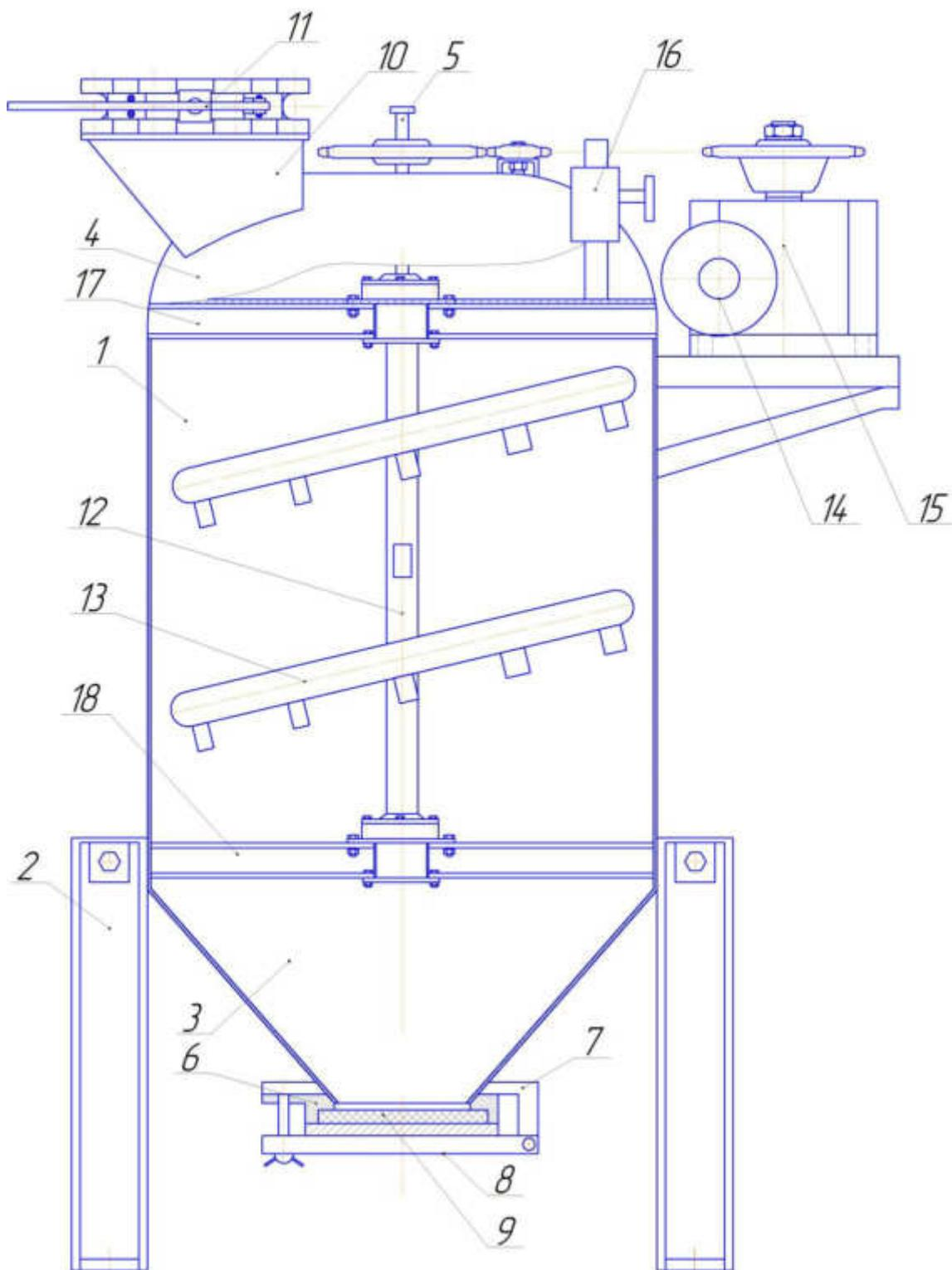
1-вертикальная овальная ёмкость; 2-рама; 3-конический выгрузной корпус; 4-овальная крышка; 5-парораспределительный патрубок; 6-фланец; 7-кронштейн; 8-откидная крышка; 9-уплотнительная манжета; 10-приёмный бункер; 11-задвижка; 12-вал; 13-парораспределительный патрубок; 14-редуктор; 15-электродвигатель; 16-патрубок для отвода и сброса вторичного пара; 17,18-опоры.
