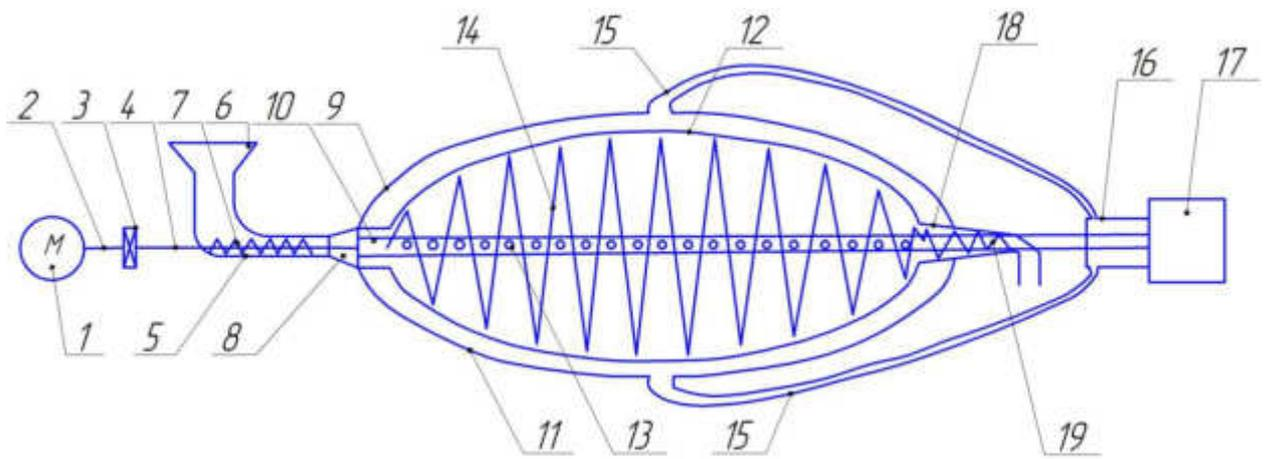
1 – электродвигатель; 2 – приводной вал; 3 – передаточная муфта; 4 – вал; 5 – загрузочный корпус; 6 – загрузочное отверстие; 7 – подающий шнек; 8 – запорный клапан; 9 – овалный корпус; 10 – полый вал; 11 – паровая рубашка; 12 – внутренне отверстие; 13 – отверстие для выхода пара; 14 – шнек; 15 – паропроводящий трубопровод; 16 – парораспределитель; 17 – парогенератор; 18 – выгрузной патрубок; 19 – конусный шнек.
