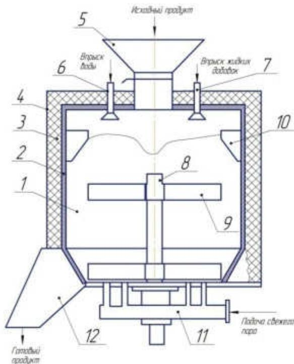
1 – рабочая камера; 2 – нагревательный элемент; 3 – термоизоляционная рабочая камера; 4 – защитный кожух; 5 – загрузочный шлюз; 6 – форсунка; 7 – форсунка; 8 – вал; 9-лопасти; 10 – завихритель потока; 11 – патрубок подачи пара; 12 – выгрузной шлюз.
