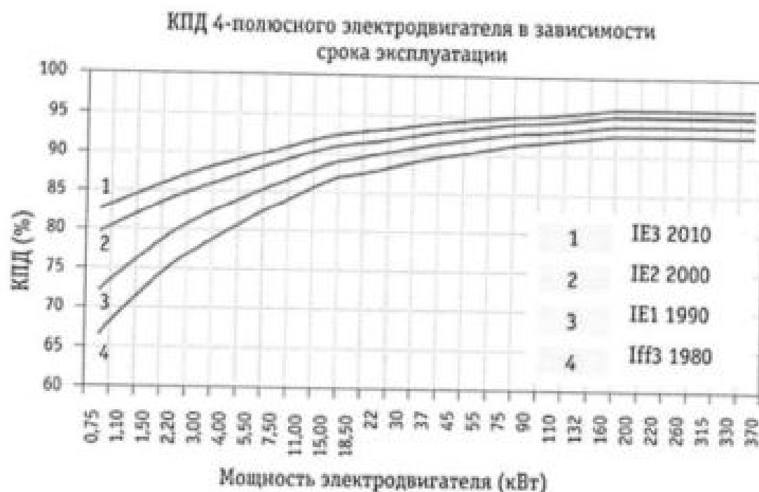
Рисунок 3.7 – Влияние класса энергоэффективности электродвигателя на КПД насоса
