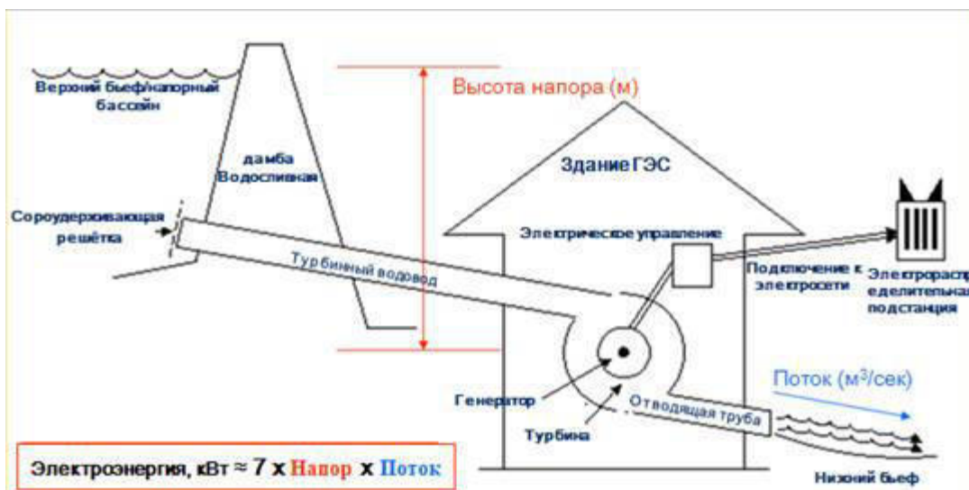
Рисунок 1.1 -- Принципиальная схема ГЭС
