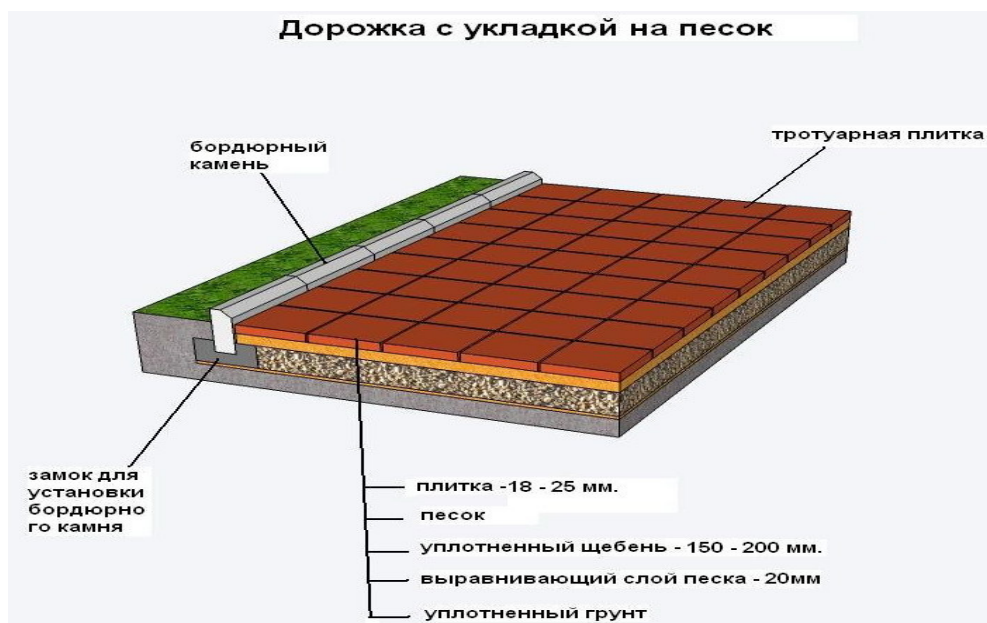
Рис. 18. Схема укладки брусчатки.
