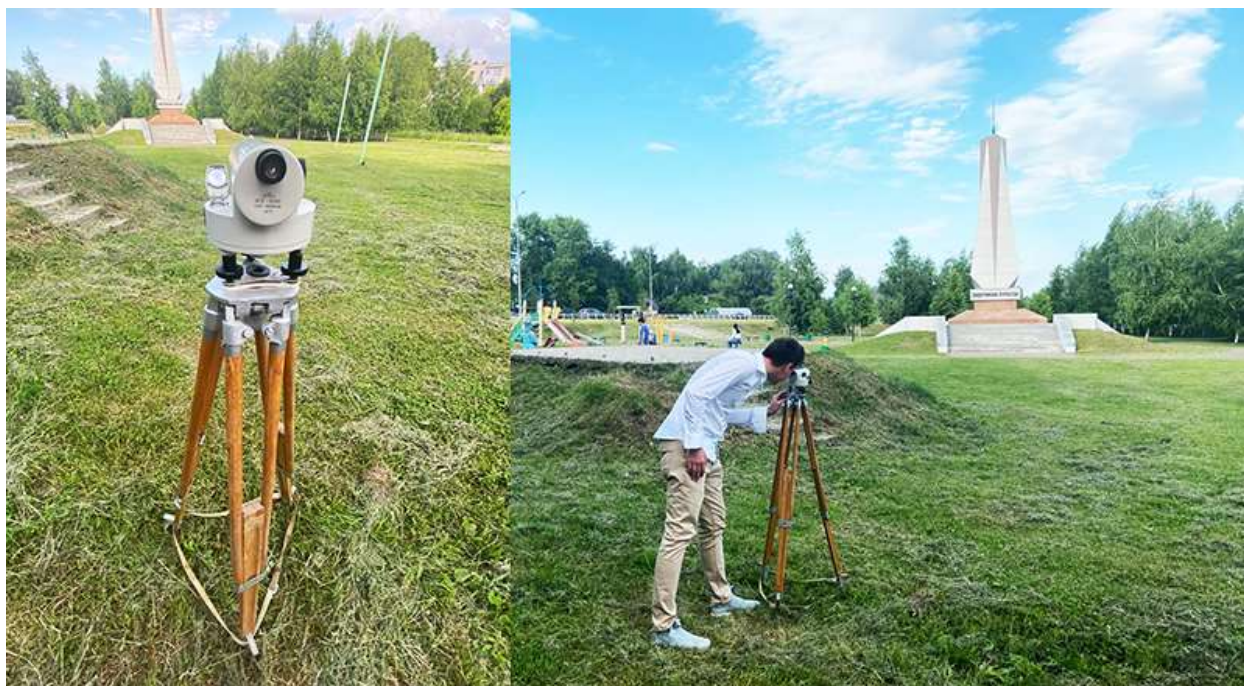
Рис. 7. Замер точек высот нивелиром «ЗМИ №386 ГОСТ 10528-69 1977г.».
