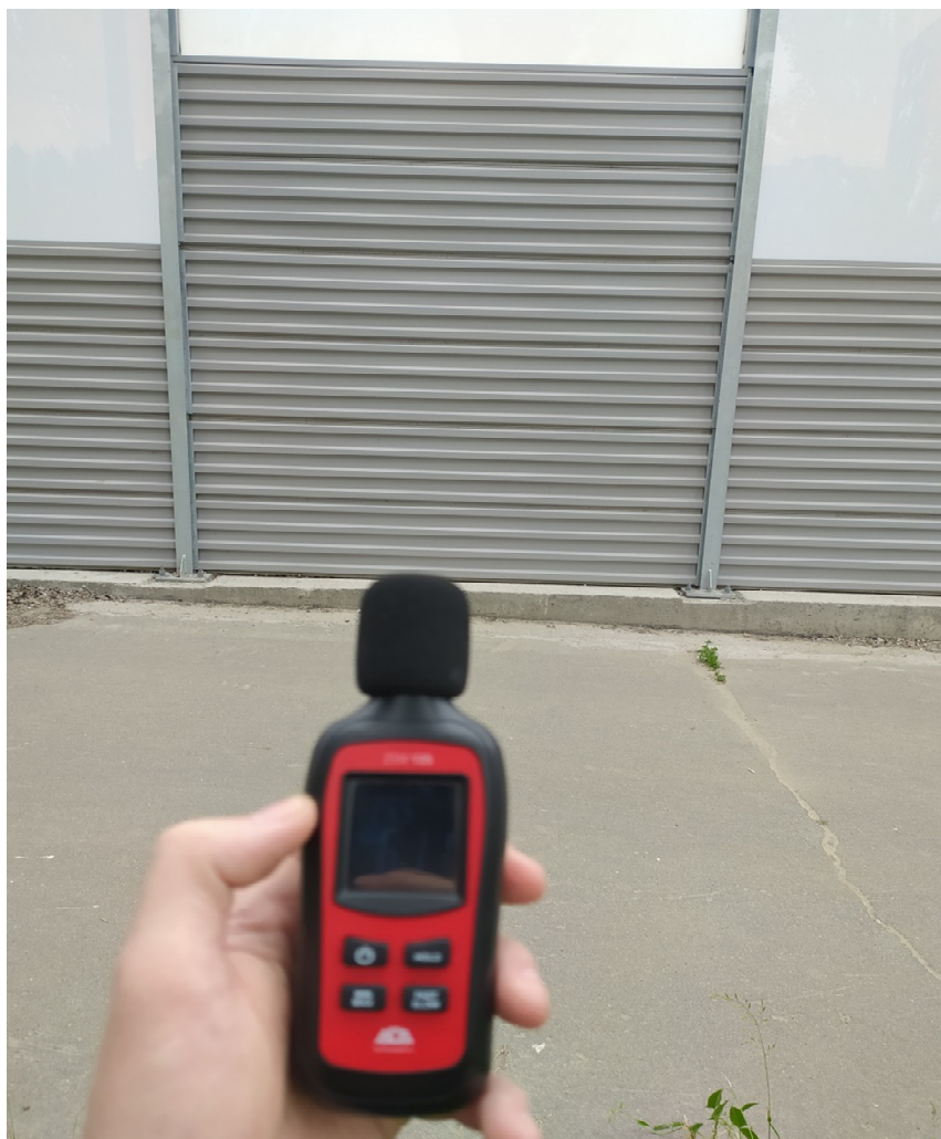
Рис. 3.9 – Изучение эффективности шумоизолирующих экранов
