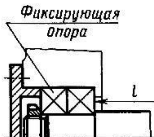
Рисунок 3.2 – Схема установки подшипника
