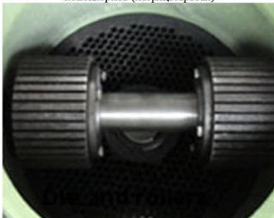
Рисунок 3.4 – проектируемый гранулятор комбикормов в сборе.
