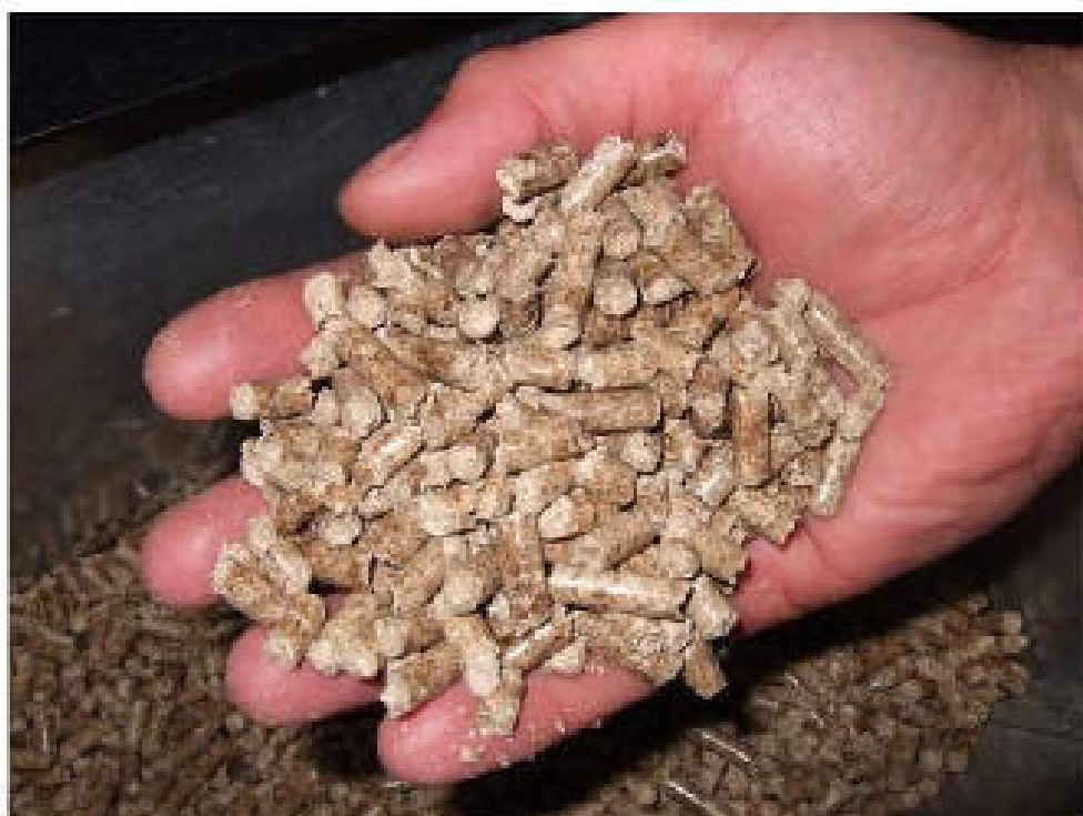
Рисунок 3.5 – полученный продукт (гранулы) при проведении опытов Основные преимущества разработанного гранулятора
