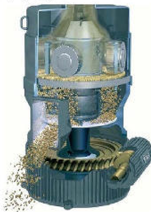
Рисунок 3.6 - конструкция гранулятора с несколькими вращающимися барабанами
