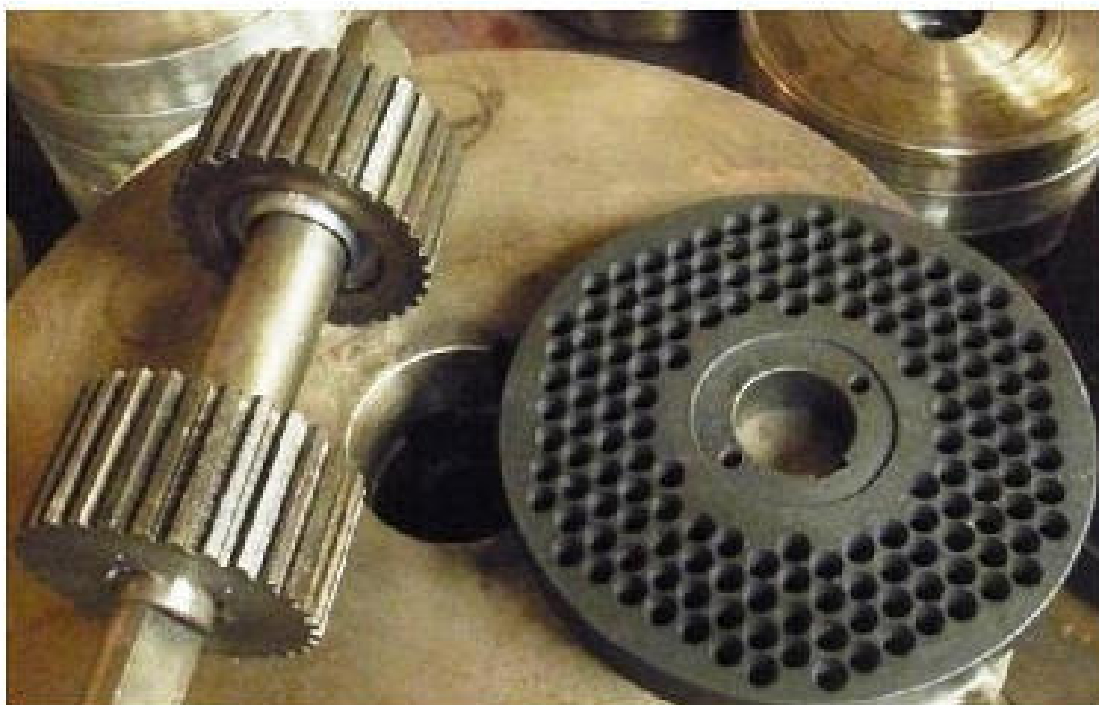
Рисунок 3.3 – комплектующие предлагаемого гранулятора комбикормов (матрицабарабан)
