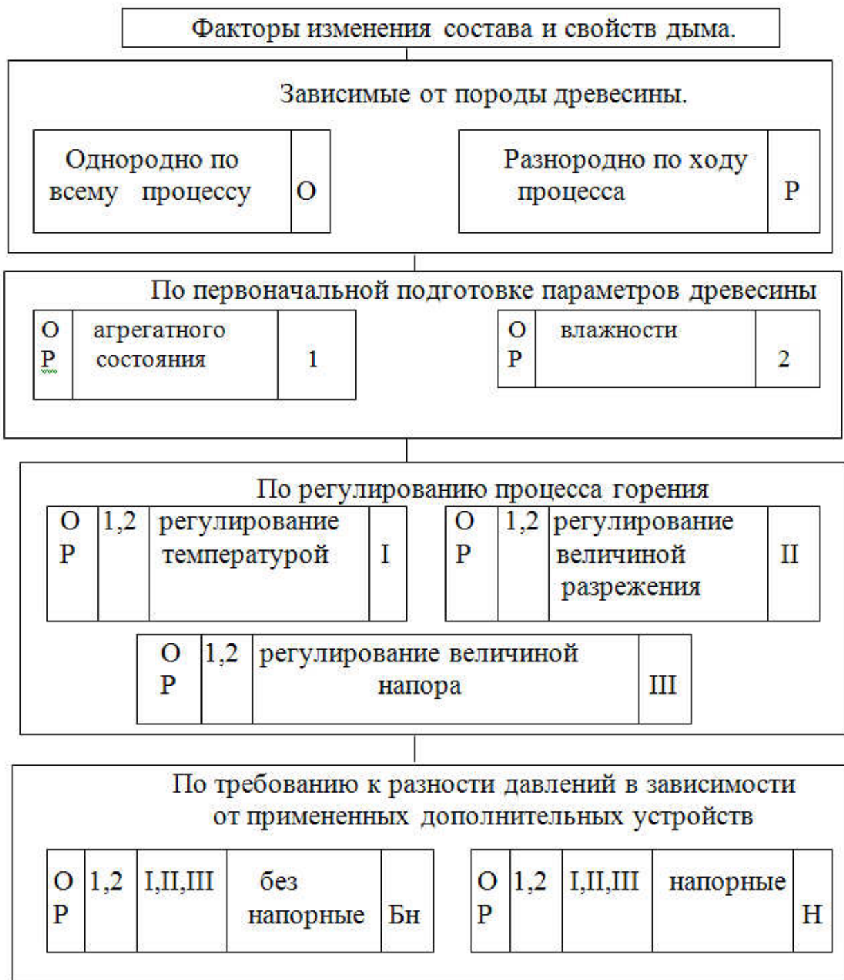
Рисунок 1.2 - Классификационная схема способов и технических методов изменения состава и свойств дыма
