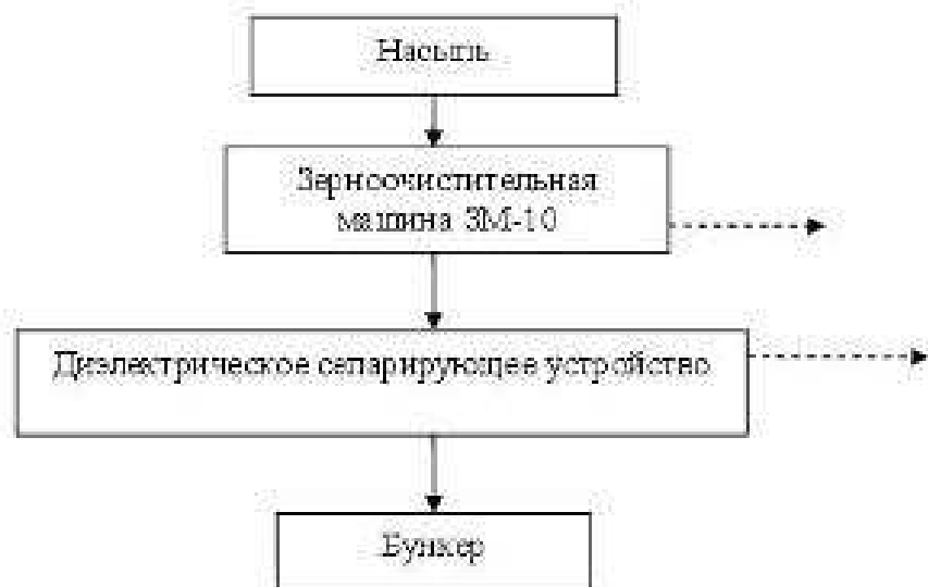
Рисунок 2.7 - Блок-схема линии обработки семян
