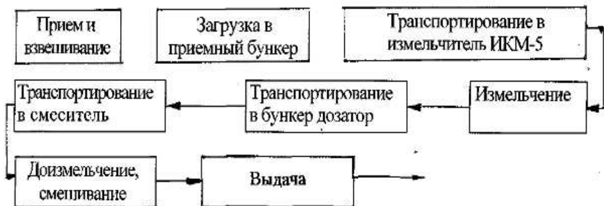
Рисунок 2.3 - Диаграмма обработки корнеклубнеплодов
