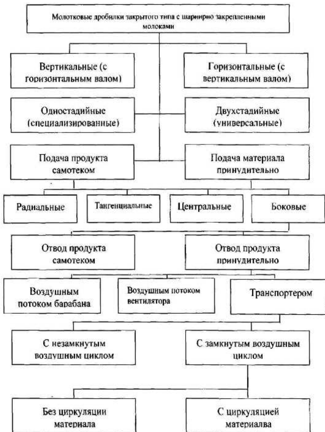
Рисунок 1.1 - Классификация молотковых кормодробилок по способу организации рабочего процесса.
