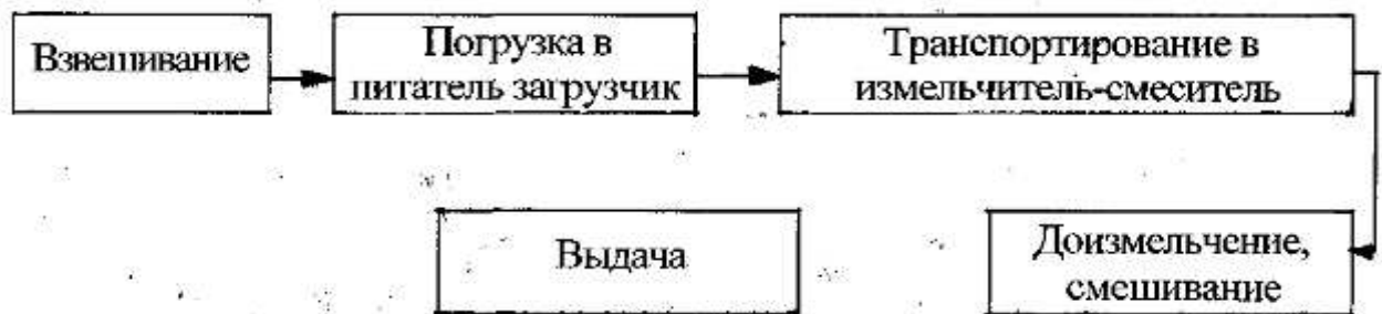
Рисунок 2.2 - Диаграмма обработки грубых кормов и силоса.
