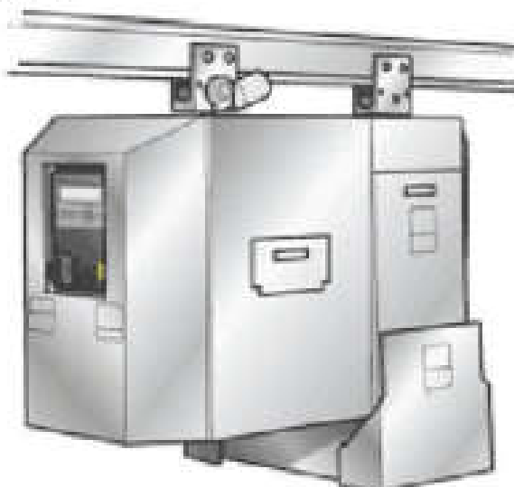
Рисунок 3.1- Подвесной кормораздатчик ПКР-5
