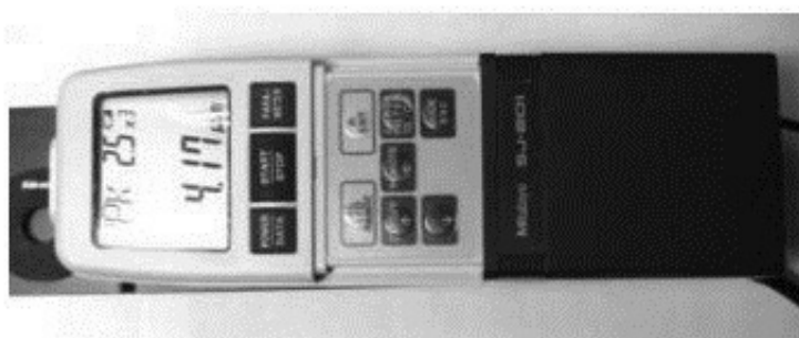
Рисунок 3.4- Измерение шероховатости образцов с помощью прибора профилографа-профилометра Mitutoyo SJ-201P
