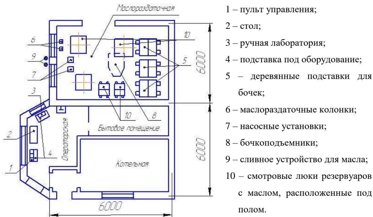
Рисунок 1.2 – План операторской с маслоскладом и маслораздаточной (нефтесклада емкостью 40, 80 и 150 м<sup>3</sup>)
