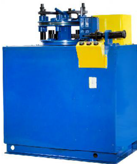
Рисунок 1.2 – Стенд для срезания тормозных накладок Р-174
