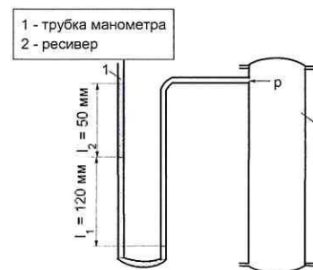
Рисунок 1.2 – Схема ресивера и манометра
