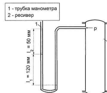
Рисунок 1.2 – Схема ресивера и манометра
