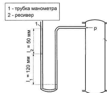
Рисунок 1.2 – Схема ресивера и манометра
