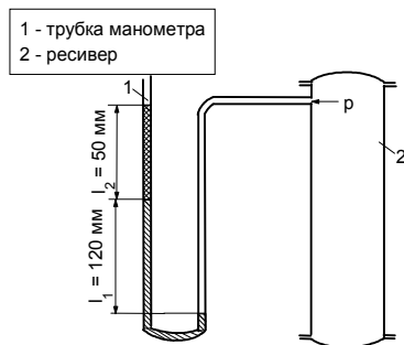
Рисунок 1.2 – Схема ресивера и манометра
