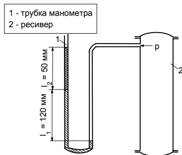
Рисунок 1.2 – Схема ресивера и манометра
