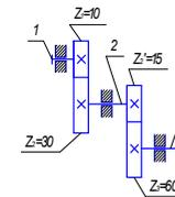
81. Передаточное число многоступенчатого редуктора определяется по формуле:
