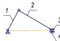
17. Изображённый на рисунке механизм имеет степень подвижности, равную:
