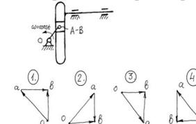
34. Ускорение Кориолиса будет присутствовать при определении ускорения точки:
