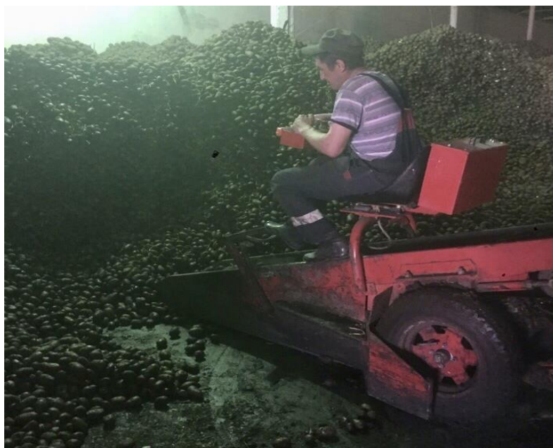
Рис. 6 – Самоходный подборщик с телескопическим конвейером
