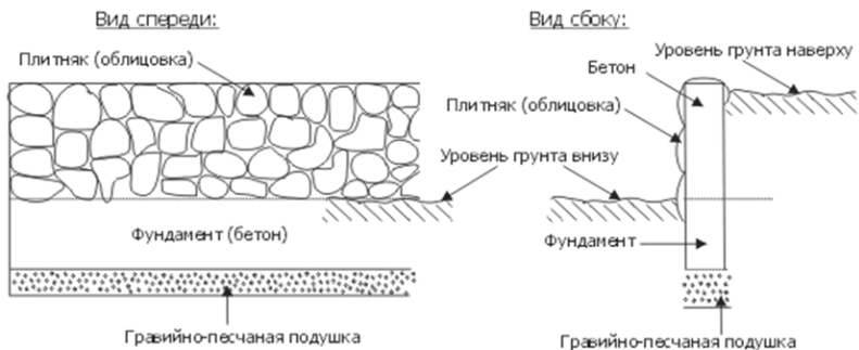
Рис. 14. Конструкция подпорной стенки из бетона
