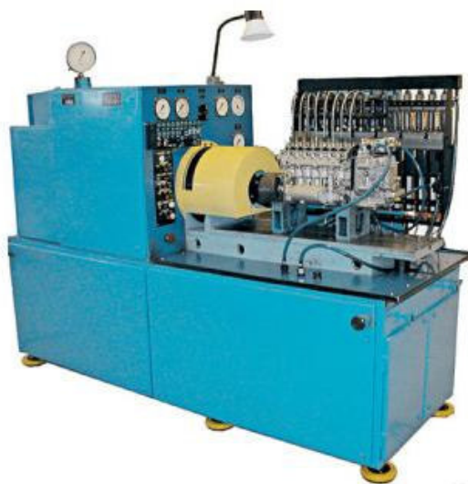
Рисунок 11 – Стенд ДД-10-05 для испытаний, регулировки и диагностики ТНВД дизельных двигателей
