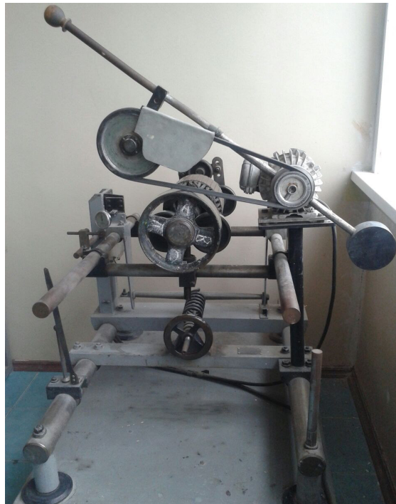
Рисунок 7 - Балансировочный станок конструкции Б.В. Шитикова
