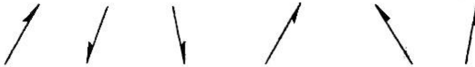
Рисунок 7 – Обозначение одинаковых швов в случае если все швы одного типа
