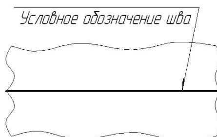
Рисунок 5 - Условное изображение шва с обратной стороны
