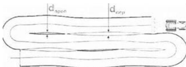
Рис.10. Ошибки механизатора: где d_{\text{проп}} - пропущенные участки; d_{\text{пер}} - перекрыты участки
