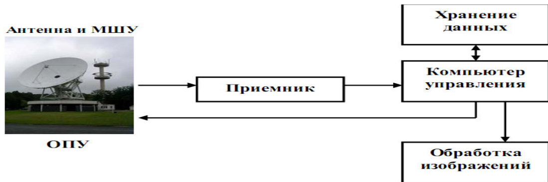
Рис.3.7. Схема станции приема информации со спутника.
