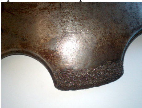
Рисунок 5 – Рабочая зона дискового рабочего органа обработанная вибродуговым методом
