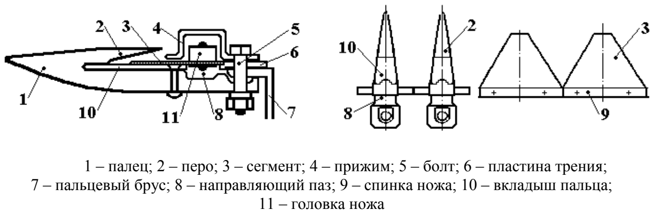
Рисунок 8 – Устройство режущего аппарата
