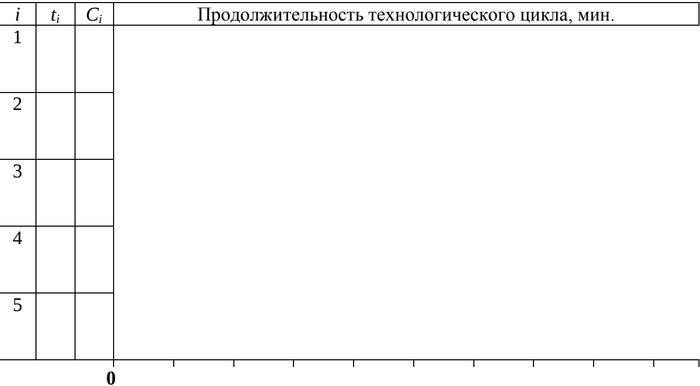
Рисунок 3.2 – График длительности технологического цикла при параллельно-последовательном виде движения партии деталей
