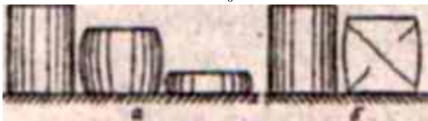
а - пластичный материал; б - хрупкий материал
